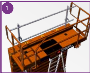
1 Protection côté face coffrante escamotable électrozinguée
