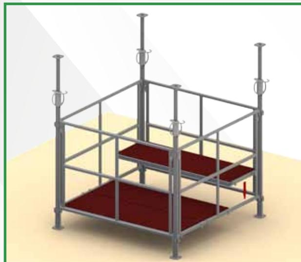
8 - Positionner les plançons sur la membrure inférieure du cadre
