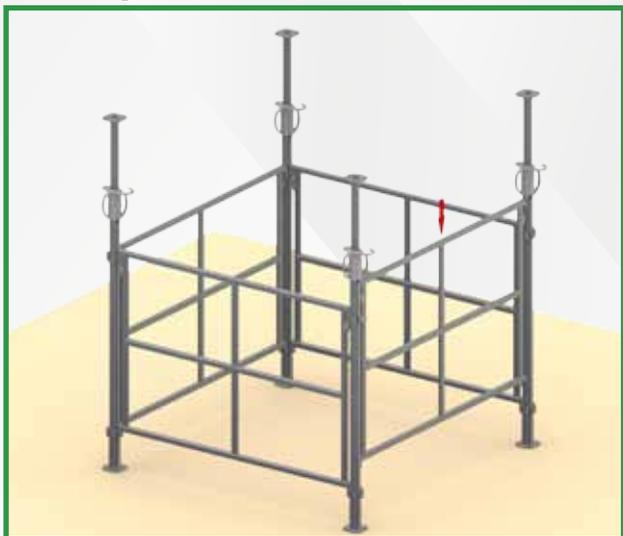
7 - Installer le 4<sup>e</sup> étage et le 4<sup>e</sup> cadre
