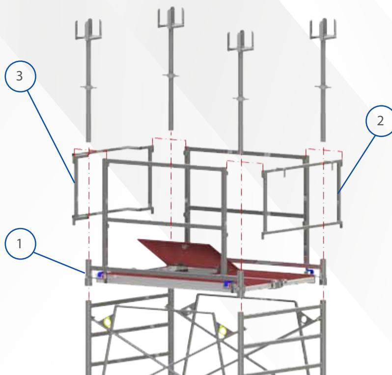
**NOTA :** les garde-corps de clavetage poutres s'utilisent **UNIQUEMENT** avec des fourches réglables.
