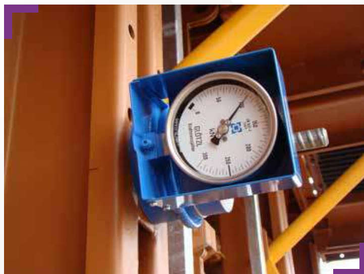
CELLULE DE CHARGE MONTÉE SUR L'ENTRETOISE HAUTE DE LA BANCHE
