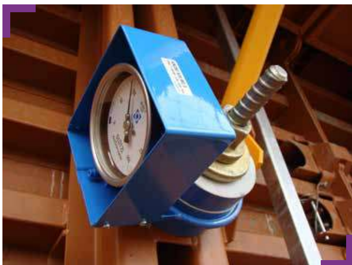
CELLULE DE CHARGE MONTÉE SUR L'ENTRETOISE HAUTE DE LA BANCHE
