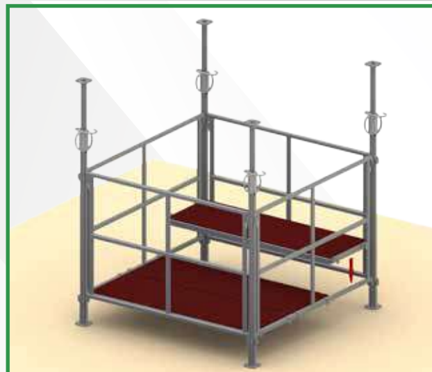
8 - Positionner les planchons sur la membrure inférieure du cadre
