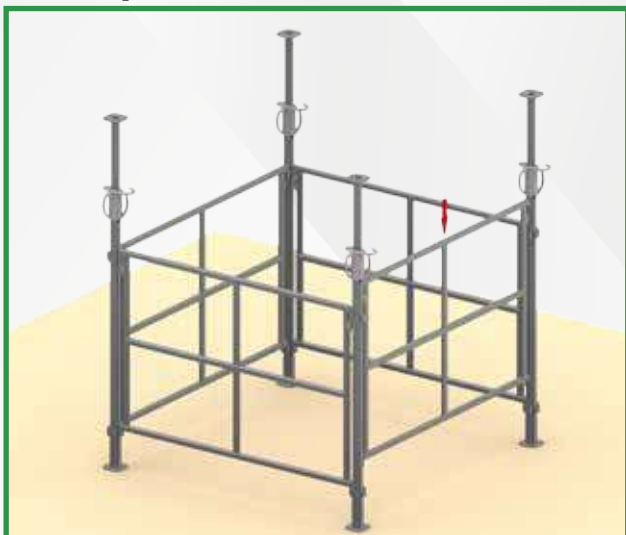
7 - Installer le 4 e étage et le 4 e cadre
