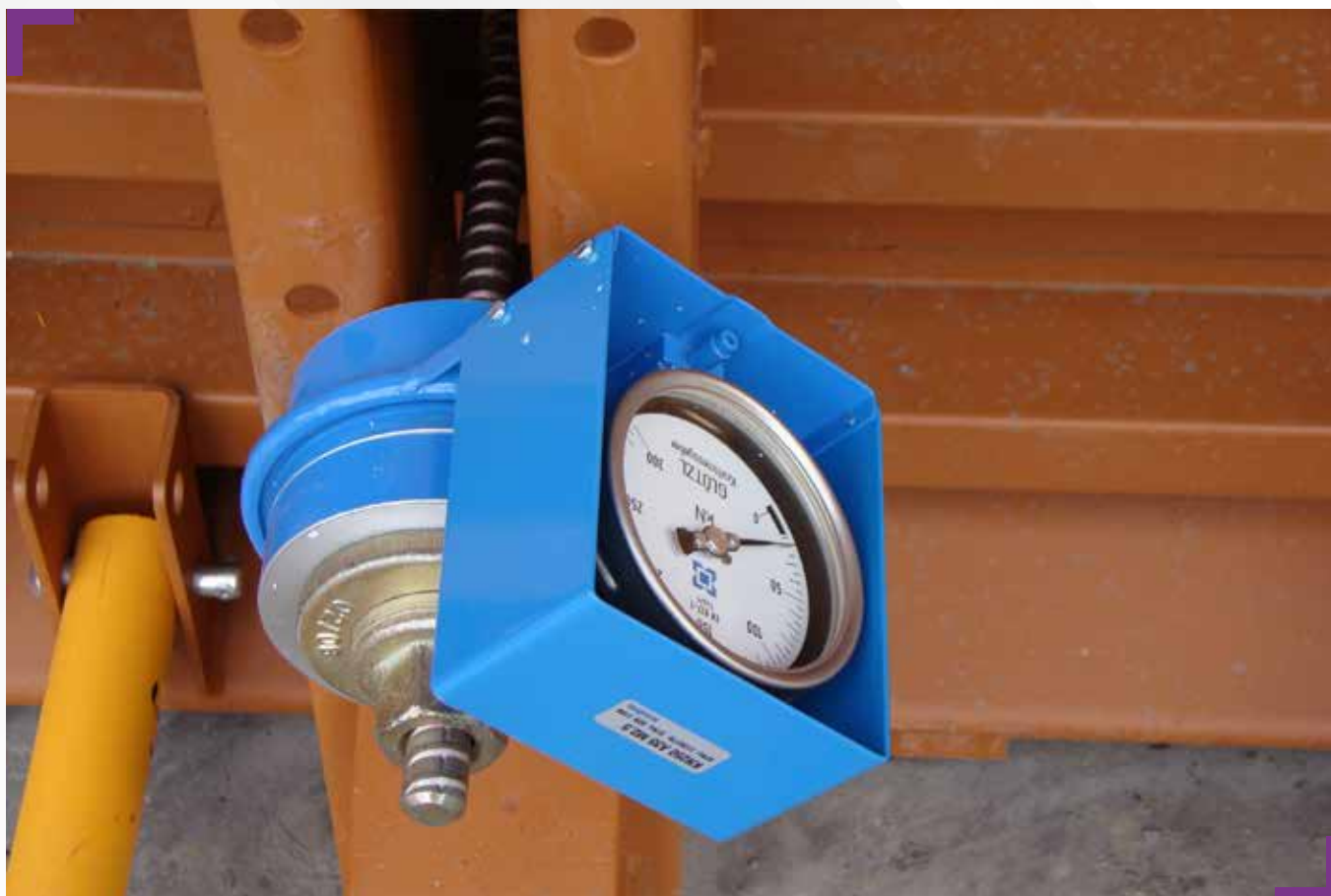
CELLULE DE CHARGE MONTÉE SUR L'ENTRETOISE BASSE DE LA BANCHE
