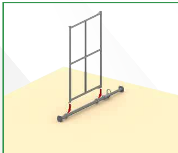
2 - Fixer le 1 er cadre sur le 1 er étau
