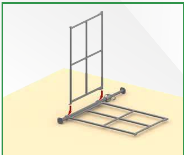
3 - Fixer le 2 d cadre sur le 1 er étau
