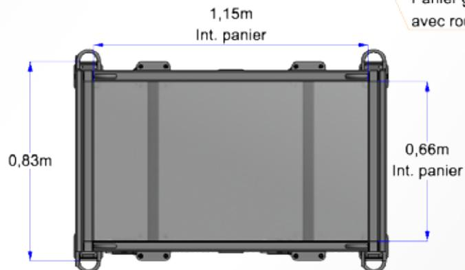
Pour le stockage des poutres et des panneaux, UN seul panier en DEUX versions :
