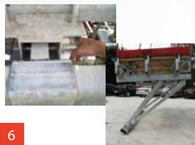
Dégoupillez le pied de console de la position centrale et regoupillez-le sur la face avant de la plateforme
