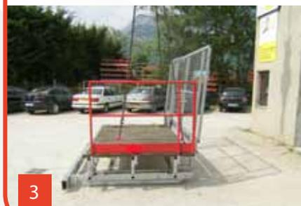
Rajouter si nécessaire une extension haute de garde-corps ainsi que les trois extensions basses de plateformes
