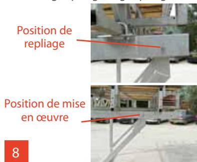
Régler la hauteur des pieds de ferme selon l'application sur le support (par axe/goupille)
